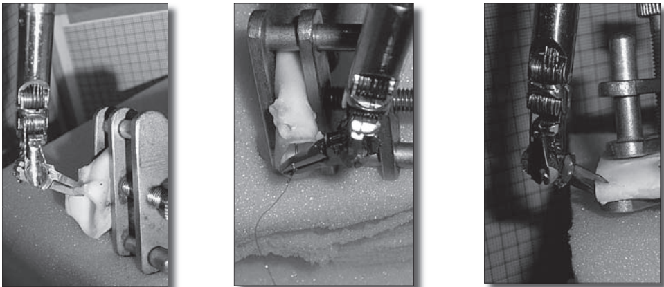
Rys. 8. Badania funkcjonalne a) ciągnięcie tkanki, b) szycie, c) cięcie.
