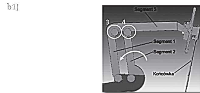
Rys.7 a) Charakterystyka momentu napędowego serwowalnika 2 DOF b) wartości reakcji w przegubach 3,4 części SLAVE telemanipulatora
