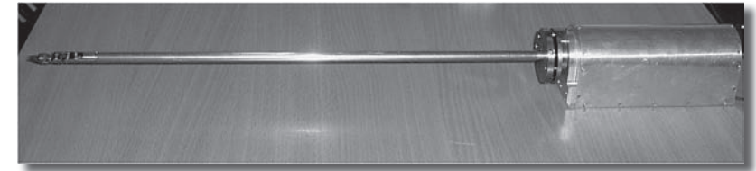
Rys. 4. Blok napędowy narzędzia z zamontowanym narzędziem.
