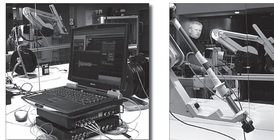
Rys. 1 Optymalizacja sposobu mocowania ramienia RH Vision bazując na pomiarze wibracji końcówki endoskopu umieszczonego na ramieniu telemanipulatora. badania drgań końcówki robota przeprowadzono korzystając z zestawu pomiarowego: przetwornik analogowo cyfrowy SIGLAB dwa akcelerometry trójosiowe laptop z oprogramowaniem Matlab/Siglab
