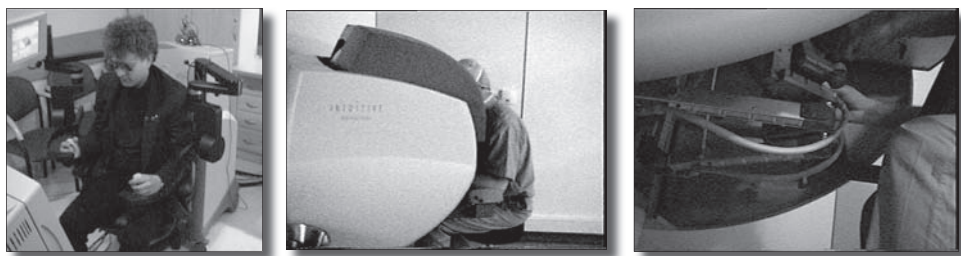
Rys.3 Interfejs użytkownika robota Zeus (a) oraz robota daVinci (b)
