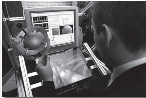
Rys. 5 Konsola sterownicza: zadajnik Master robota narzędziowego (po lewej), monitor pola operacyjnego (poniżej), monitor techniczny (powyżej) konfigurowany wg życzenia operatora
