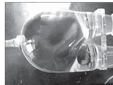
d - Zakończenie fazy napełniania: membrana zaczyna wykładać się w kierunku powierzchni czaszy pneumatycznej, pofałdowania zanikają
