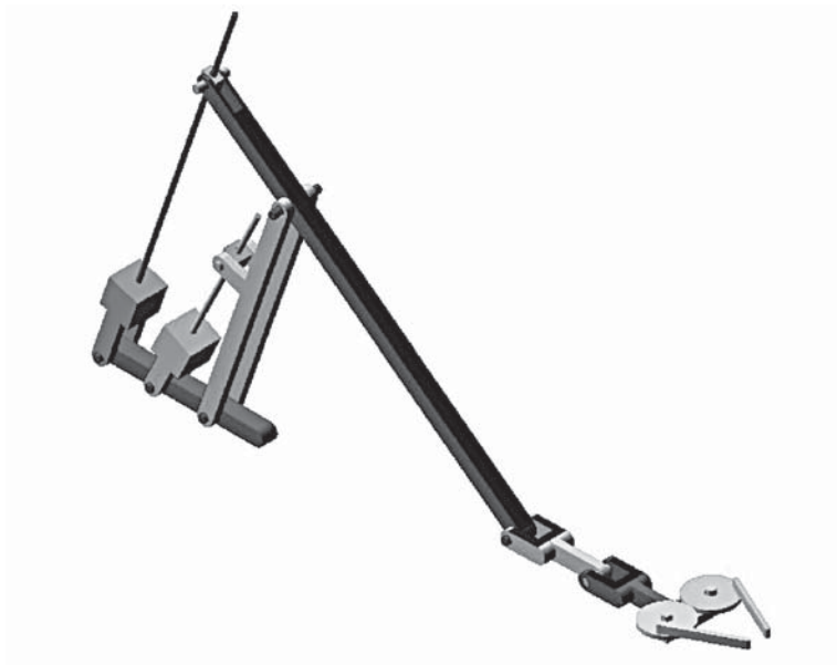
Rys.1. Model w systemie MSC.Adams, wykonany do symulacji kinematyki i dynamiki manipulatora
