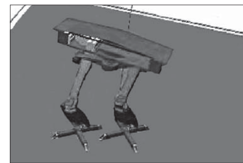
Symulacja drugiego projektu koncepcyjnego. Nie posiada chwytaka ale korpus zostaje pod stałym kątem do kierunku ruchu
