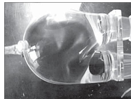
c - Przejście membrany przez płaszczyznę środkową: widoczne duże pofałdowania powierzchni i nieregularności kształtu
