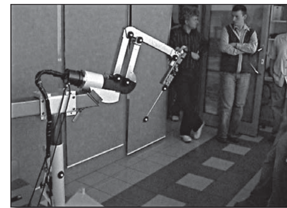
Rys. 2 Rozmieszczenia markerów w parach kinematycznych obrotowych
